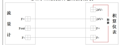
带显示三线制脉冲输出接积算仪
