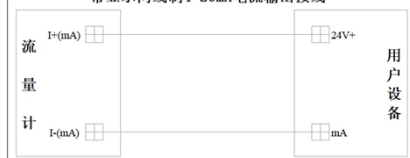
带显示两线制4~20mA电流输出接线
