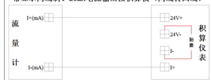
带显示两线制4~20mA电流输出接积算仪 (两线转四线)
