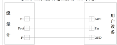
带显示三线制脉冲输出接线 (24V供电)
